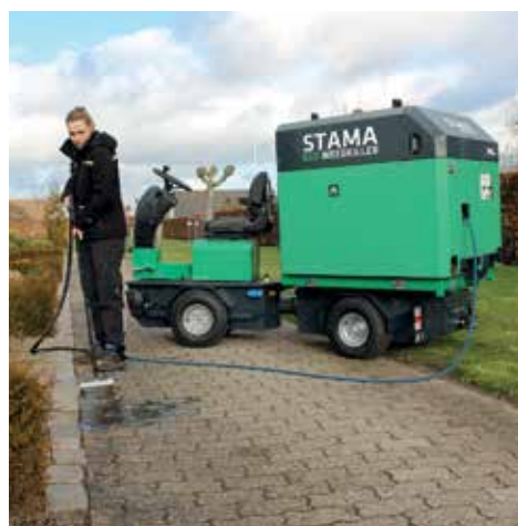
Et nyt tiltag er batteridrevet ukrudts-bekæmpelse med varmt vand
